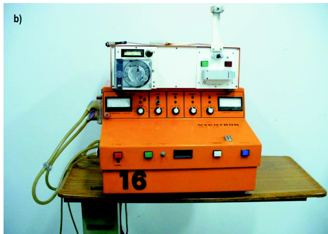
Rycina 10 Sztuczna nerka NYCOTRON a) dializator arkuszowy; b) Zestaw monitorujący z pompami. Artificial kidney NYCOTRON a) plate dialyzer; b) monitoring unit with pumps.
