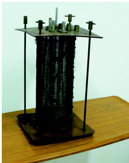
Rycina 7 Pierwszy dializator zwojowy produkcji Politechniki Krakowskiej stosowany w Klinice. First dialyzer manufactured by Politechnika Krakowska used in Dialytic Unit in Krakow.
